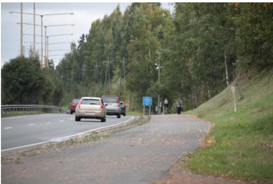
Kuva 23. Ylöjärven laatukäytävän linjaus on suora ja väylän laatutaso on monin paikoin hyvä. Sulamisvesien jäätyminen aiheuttaa liukkausongelmia erityisesti keväisin (kuva P. Metsäpuro).
