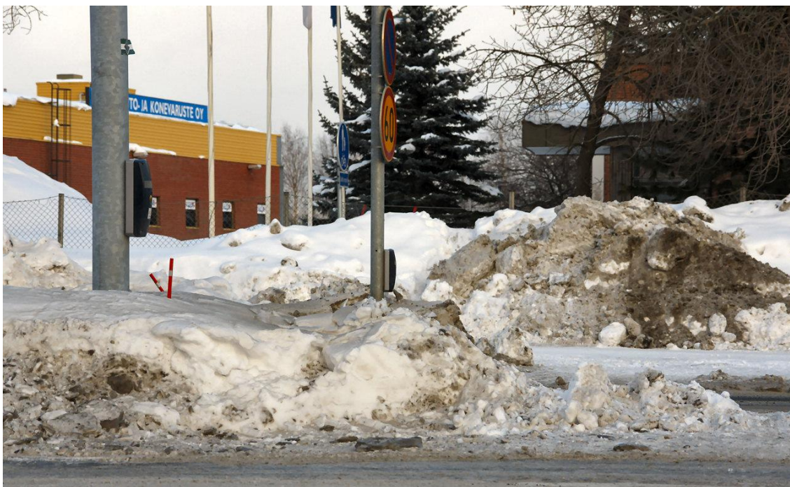
Kuva 2.5. Heikosti saavutettavissa oleva liikennevalojen painonappi. Oulu, Limingantie. (Pekka Tahkola)
