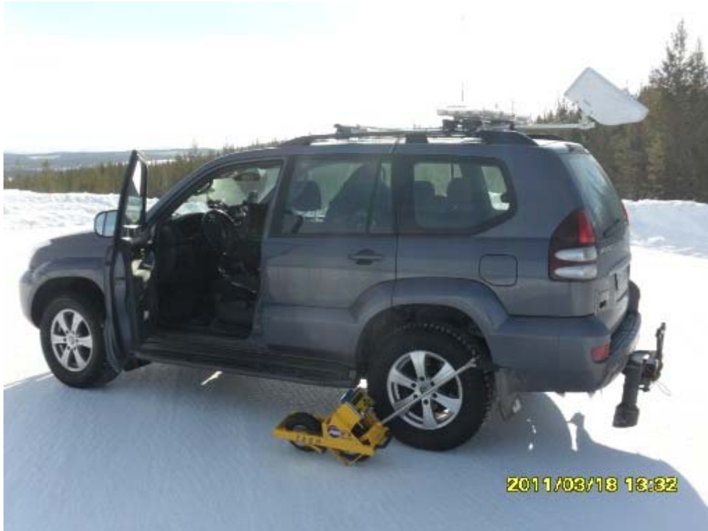
Kuva 2. Mittausauton peräkoukkuun on kiinnitetty RCM411 ja katolla on DSC111. Mittausauton vieressä on T2GO. Jarrutuskitkamittarit ovat mittausauton sisällä kojelaudan tuntumassa.
