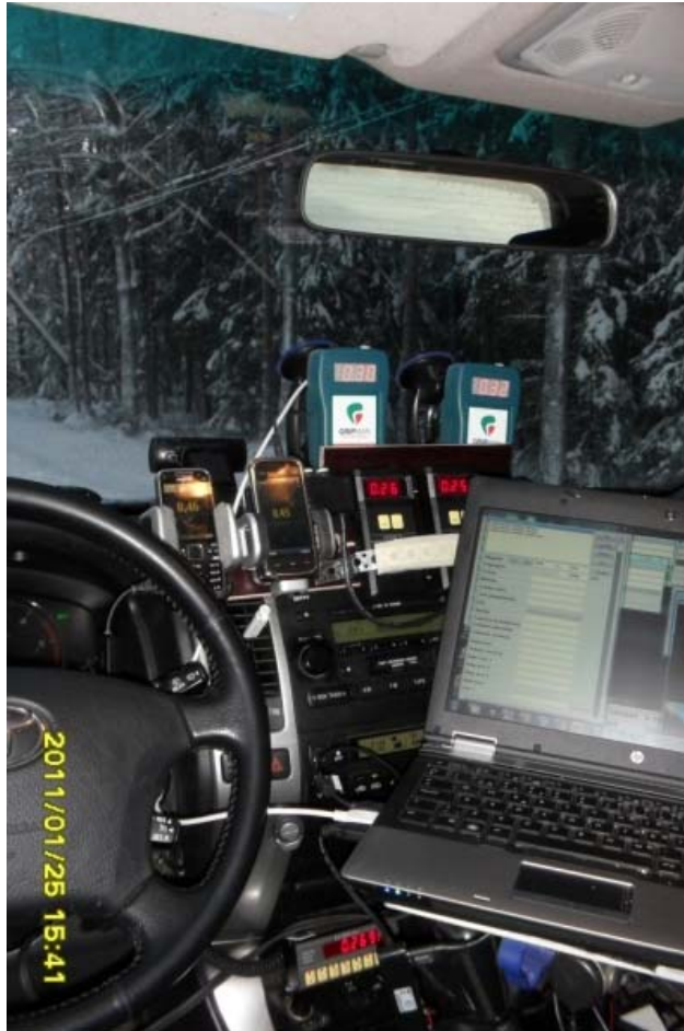
Kuva 3. Mittausauto sisältä. Ylimpänä näkyvät sinivihreät Gripmanit, sekä niiden alla uudet Eltrip-7kmb kitkamittarit. µTEC-ohjelmistolla varustetut matkapuhelimet ovat uusien Eltrippien vasemmalla puolella. Aivan kuvan alareunassa on perinteinen Eltrip-kitkamittari. Kuvassa Gripmanit ovat vielä vanhoissa telineissään, telineet vaihdettiin myöhemmin jäykempään.
